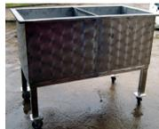
Изделие представляет собой ванну без крышки, изготовленную из нержавеющей стали. Ванна разделена на две самостоятельные секции, помещена на раму и установлена на колеса. В нижней части каждой секции ванны имеется сливное отверстие со штуцером для подключения к шаровому крану для слива отработанного моющего раствора.
