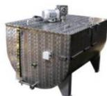
Ванна – горизонтальный трехстенный резервуар (корпус, теплообменная рубашка и облицовочный кожух), в зависимости от объема имеет одну или две мешалки, которые приводятся во вращение при помощи мотор-редуктора. Опоры ванны регулируются по высоте, что обеспечивает необходимый наклон ванны и полный слив продукта.
