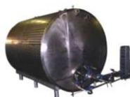
Емкость - двустенный резервуар; пространство между внутренним корпусом и наружным кожухом заполнено теплоизолирующим материалом. Для предотвращения отстоя молочного жира при хранении молока в емкости, его перемешивают при помощи молочного насоса и эжектора.
