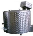
Емкость - трехстенный резервуар (корпус, теплообменная рубашка и кожух), оборудованный мешалкой (рамной или лопастной) с электроприводом и мощностью головкой; под облицовочным кожухом расположен теплоизолирующий слой.
