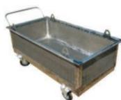
Тележка самопрессования представляет собой прямоугольную сетчатую ванну с плоским дном, установленную на колеса.
